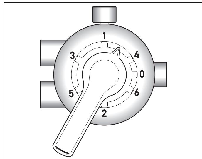
► **Controlavaggio (2):** l'acqua viene spinta dalla pompa nel filtro e viene convogliata in senso contrario all'operazione di filtraggio, per la pulizia del filtro stesso. In questo caso l'acqua entra nel filtro attraverso il tubo centrale, esce dagli elementi filtranti inferiori del sistema di distribuzione interno, sale attraverso
