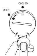
Снять крышку, используя монету в качестве рычага.
